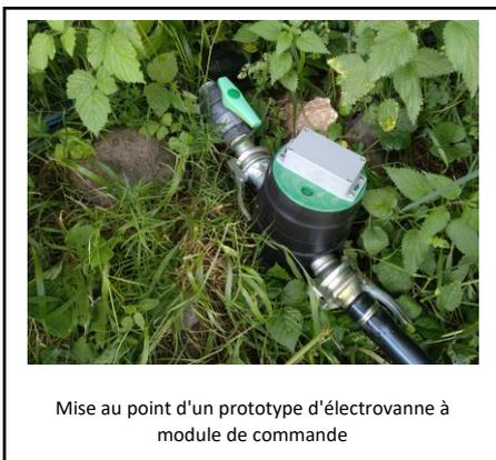
Mise au point d'un prototype d'électrovanne à module de commande
